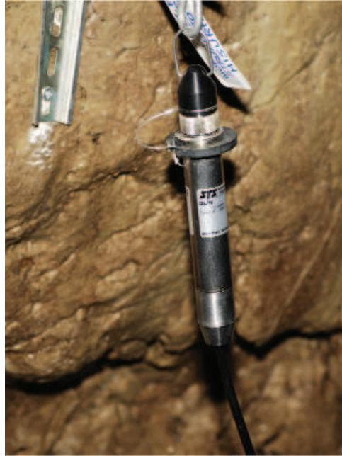
Stazione di misura delle portate nel sifone del Pre Oreak: il sensore (a sinistra) e il data logger.
