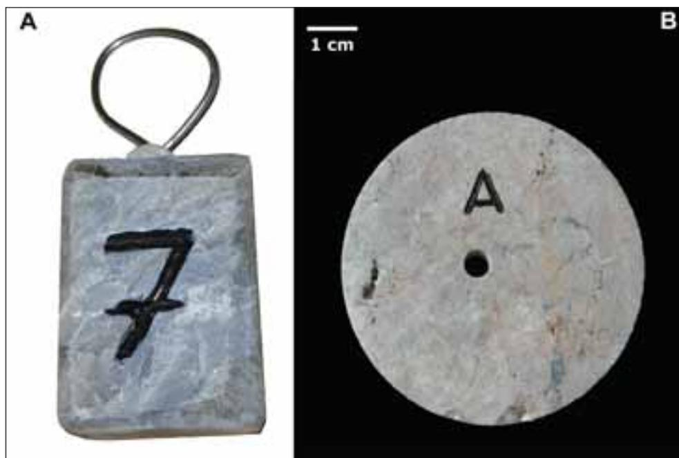
Fig. 7 - A: una tavoletta di gesso; B: una tavoletta di calcare di Naica.
