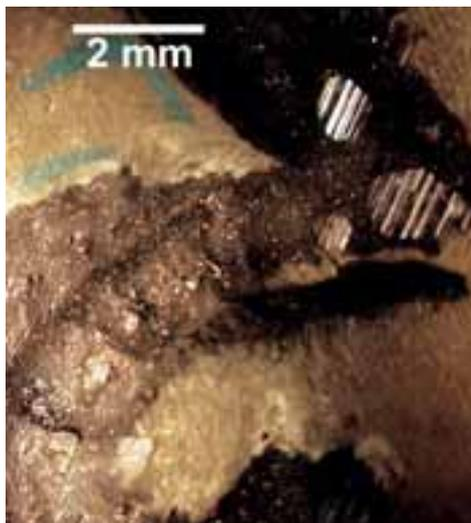
Fig. 8 - Foto al microscopio binoculare di un cristallo di gesso accresciutosi durante l'esperimento (Foto Antonio Rossi, Università di Modena e Reggio Emilia).
