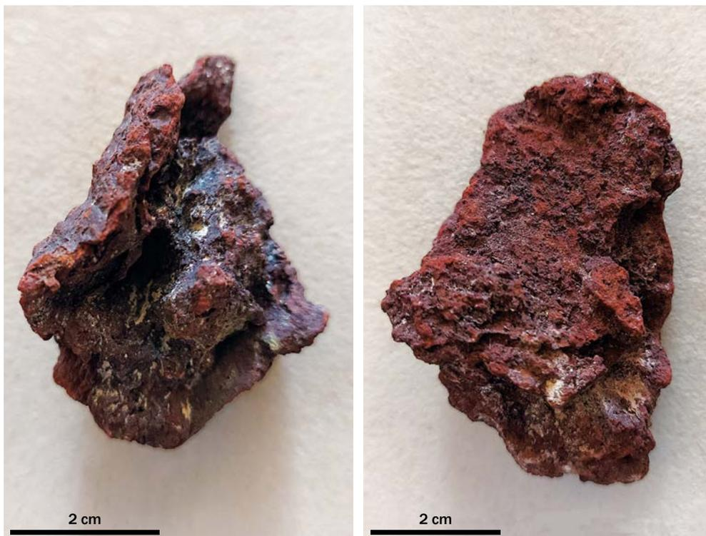
Figg. 10a e 10b - Campioni di ematite prelevati dalla volta della galleria.
