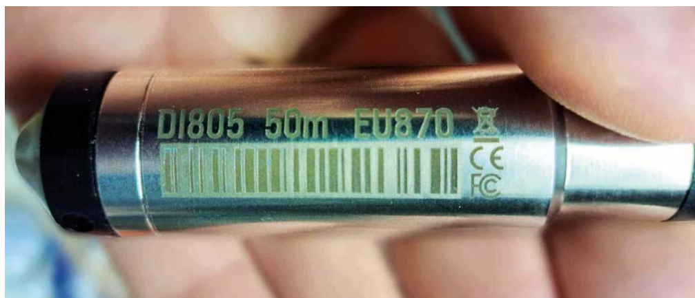
Fig. 5 - Il Diver Van Essen installato temporaneamente alla sorgente Fontanate.
