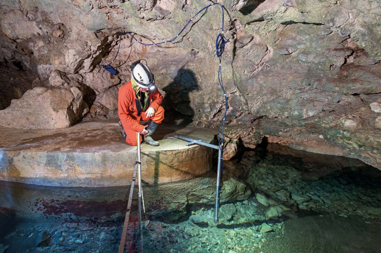
Fig. 6 - La stazione di rilevamento dati con i due strumenti installati (foto A. D'Andrea).
