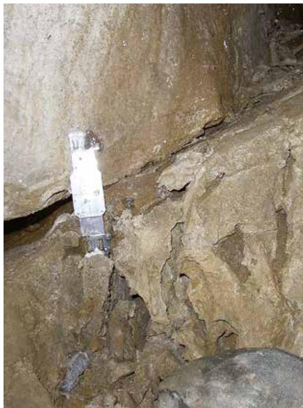
Posizionamento di un ventrino di controllo nella Caverna sulla mulattiera del Pal Piccolo (foto M. Solari).
