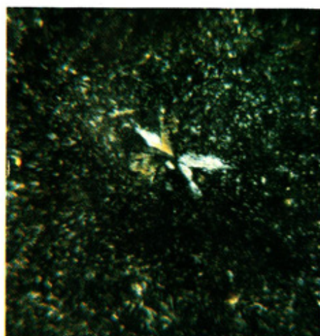
Fig. 5 - Foto ai nicols incrociati della sezione sottile della stalattite di Brushite: all'interno dei grumi di materiale scarsamente coerente possono trovarsi cristallizzazioni a "rosetta" (foto P. Ferrieri).
