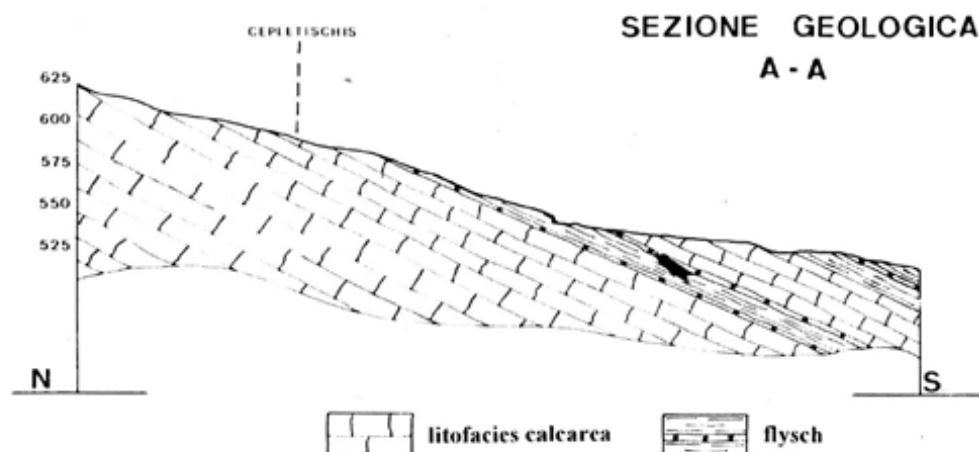
Fig. 1 - Sezione geologica circa N-S, secondo la traccia indicata in tav. 1. La freccia indica la posizione della cavità.
