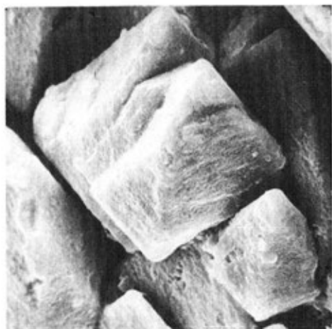
Fig. 4 - Foto al microscopio elettronico dei cristalli rombici di zolfo sulla superficie esterna delle concrezioni (x 1000, foto Paolo Ferrieri).
