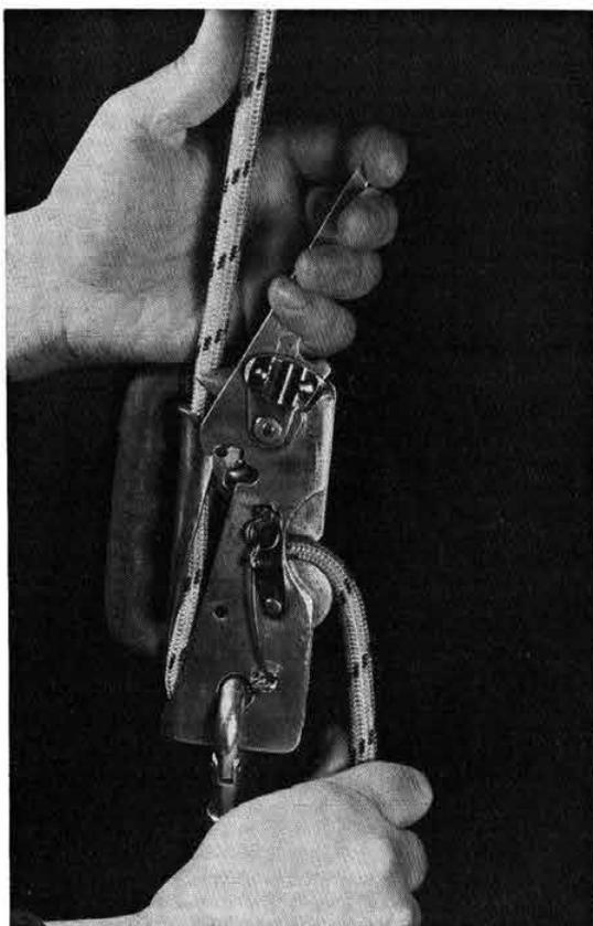
Corretta impostazione della fune e dell'operatore con l'universore usato a discensore. L'operatore è agganciato solo al moschettonone portante (8) e, mentre con la destra regola la frizione della fune, con la sinistra tiene aperto il bloccante di sicurezza (2). L'universore viene sempre agganciato all'imbragatura in modo che la faccia illustrata nelle foto si trovi contro il petto dell'operatore.
