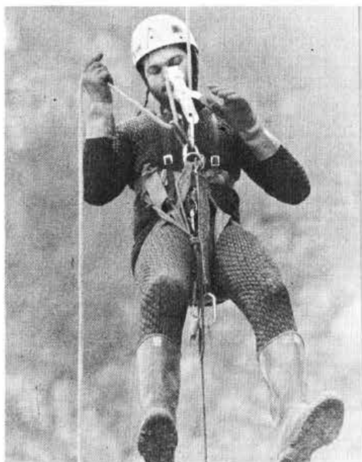
Il DIABLO in azione. L'uso del moschettone di rinvio non è indispensabile, ma su corde notevolmente viscide aiuta a regolare la velocità. L'azione bloccante è in ogni caso controllata dalla leva.
