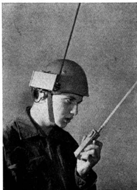
Fig. N° 3 - Il complesso ricetrasmittente al completo.
