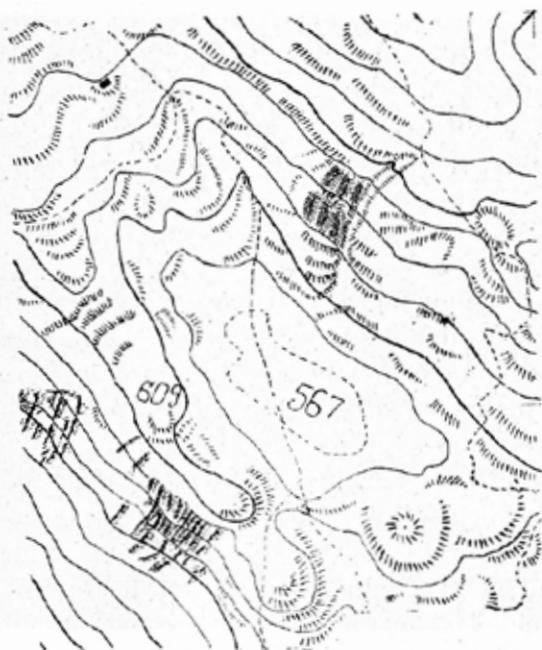
Fig. 2.<sup>a</sup> — Scala 1:10.000. — Le curve di livello continue vanno di 25 in 25 m.; quelle punteggiate di 5 in 5 m. (ingrandimento della tav. Maniago).
