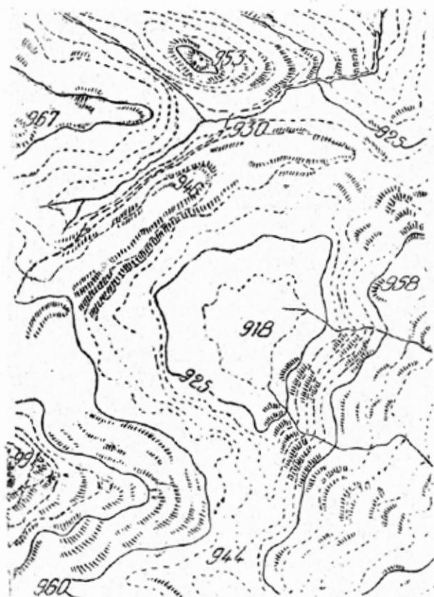
Fig. 1.<sup>a</sup> — Scala 1:10.000. — Le curve di livello continuo vanno di 25 in 25 m.; quello punteggiato di 5 in 5 m. (ingrandimento della tav. Maniago).
