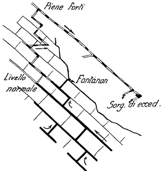
Fig. 114.<sup>a</sup> — Schizzo schematico del funzionamento delle sorgenti di eccedenza del Barman.
