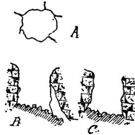
Fig. 4.<sup>a</sup> — Pozzo al piede del Bila Pec. A, pianta; B e C, sezioni. - Scala 1:500.
