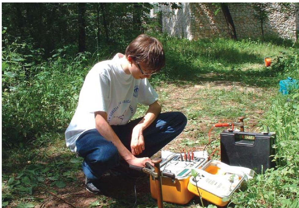
Fig. 2 - Esecuzione delle indagini geoelettriche.
